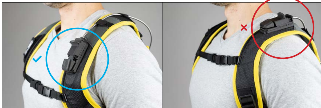
写真(左):適切に調整された肩ストラップ | 写真(右):適切に調整されていない肩ストラップ
